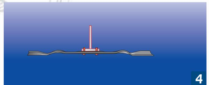
Montage einer neuen Absorber-Einheit (Absorber, Messer, Scherschrauben)
