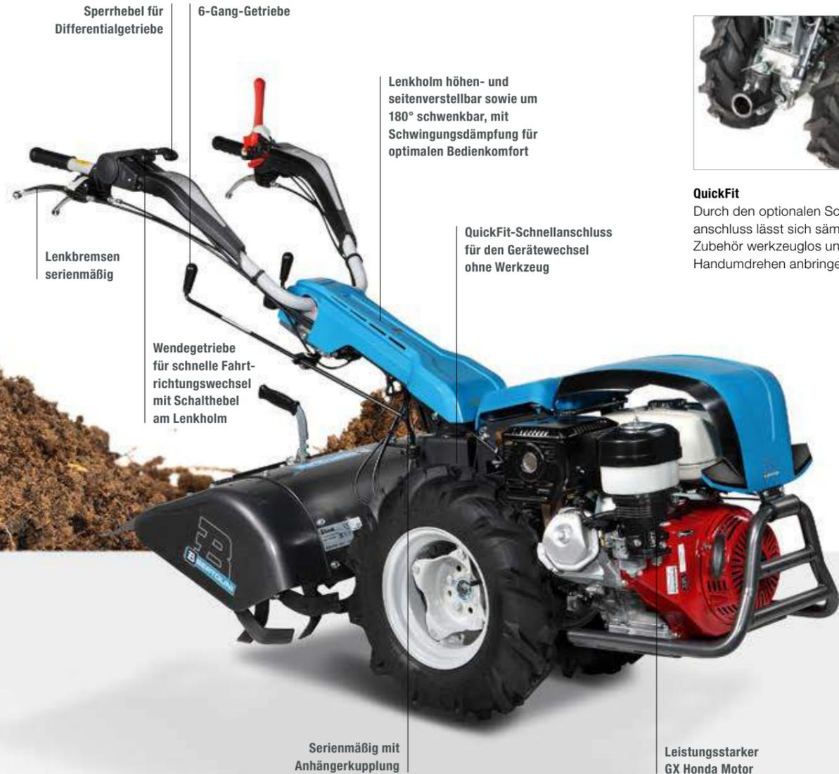
Sperrhebel für Differentialgetriebe
