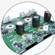
Motor + Platine mit IMS\*-Technologie mit erhöhtem Wärmetausch, mehr Leistung
