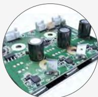
Platine mit IMS\*-Technologie mit erhöhtem Wärmetausch, mehr Leistung
