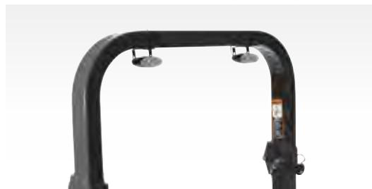
Ein am Überrollbügel befestigter Beleuchtungssatz, bestehend aus doppelten 35W-Halogencheinwerfern, die einfach angeklemt werden. Zum bequemen Bedienen über den Zündschalter wird die Halterung an den vormontierten Zubehörstecker angeschlossen.
