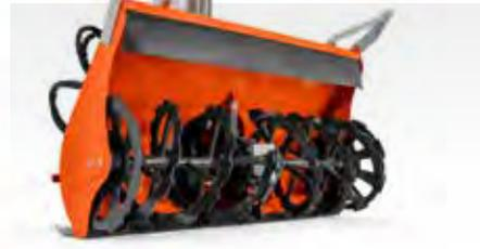
Hocheffiziente zweistufige Hochleistungs-Schneefräse. Erfordert Hydrauliksatzz und Gegengewicht. Arbeitsbreite 120 cm. Auswurfdrehung 300 Grad.
