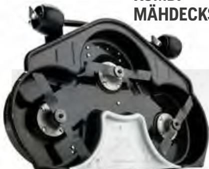
Die Husqvarna Kombi-Mähdecks vereinen eine sehr effiziente BioClip® Mulchfunktion mit Heckauswurf. Das robuste Bauteil wird aus einem 3 mm starken Stahlblech gestanzt, was zu einer hohen Effizienz dank des optimierten Luftdurchsatzes beiträgt. Sie können zwischen Mähbreiten von 103 cm (41"), 112 cm (44") oder 122 cm (48") wählen.
